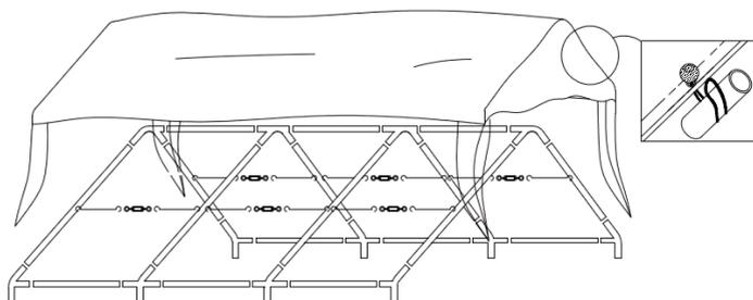
Inclinez l'un des côtés de la structure pour enclencher les pieds (tubes n°3) dans les jonctions A et B.
