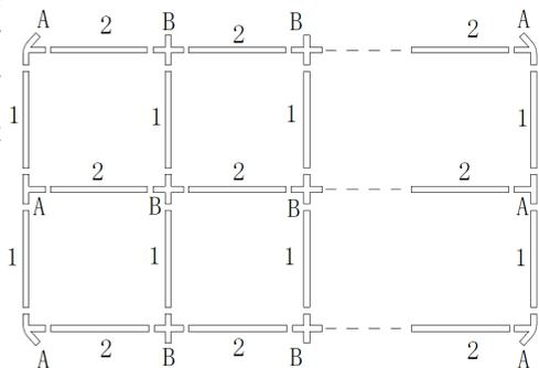
Attachez les tiges aux tendeurs et aux tubes n°1. Serrer les tendeurs pour avoir une tension optimale.
