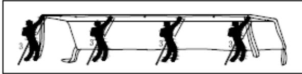
Inclinez l'un des côtés de la structure pour monter les pieds (tubes n°3) dans les jonctions A et B et fixer avec les vis M8\*65.
