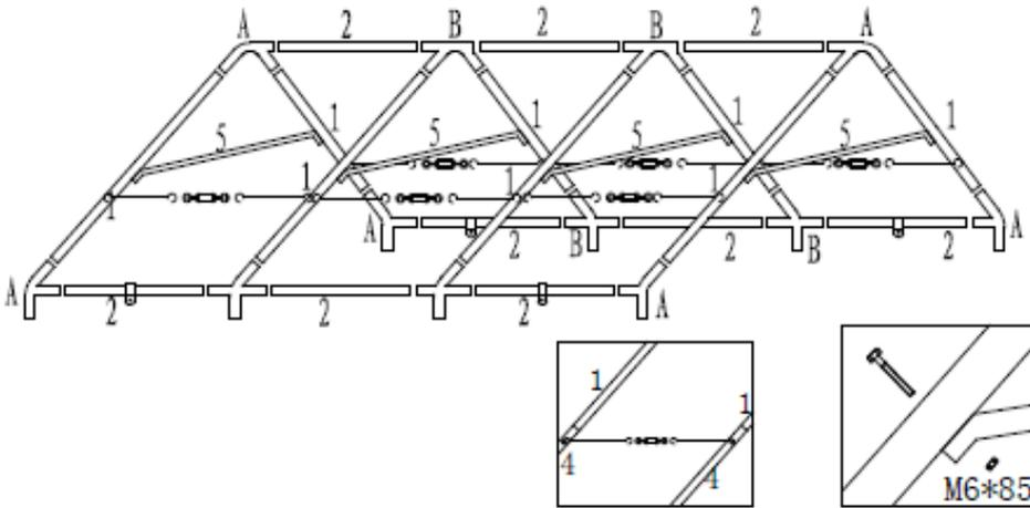
Mettez en place les barres de renfort du toit n°5 en les reliant au tube n°. Visser à l'aide des vis M6\*85. Une fois installée, elles doivent être parallèles les unes aux autres.
